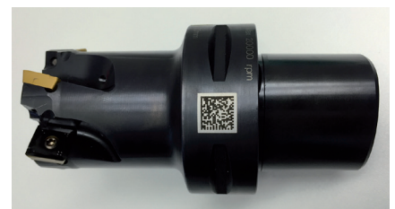
Gravierter Eckfräser mit Capto C6
