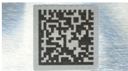
Gravierte Standard-Datamatrix Schwarz auf Weiss.
