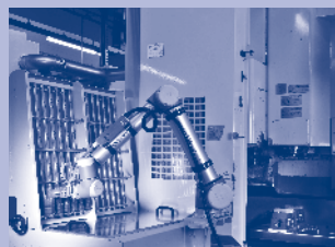
3-Achs-BAZ mit Roboterdirektbeladung
